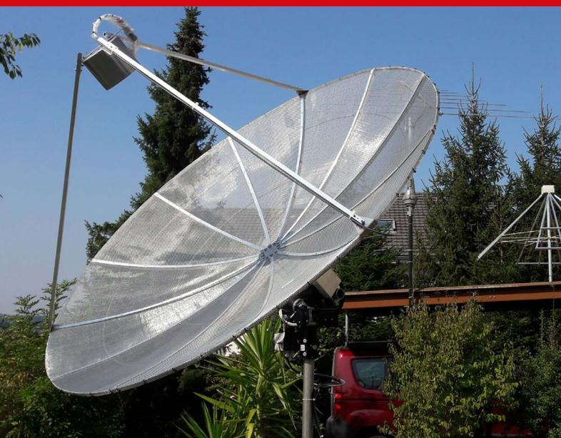
**Bild: Parabolantenne (D1m9) mit einem Durchmesser von 1.9 Meter und mit einem Horn – einem ausgedienten Milchkesseli – abgestimmt auf die Frequenz des neutralen Wasserstoffs bei 1420 MHz. Direkt am Horn ist auch der Frontend-Verstärker (Nooelec SAWbird) montiert. Damit möglichst wenig Störungen eingekoppelt werden, ist es wichtig dieser Frontend-Verstärker so nahe wie möglich am Dipol anzuordnen.**
