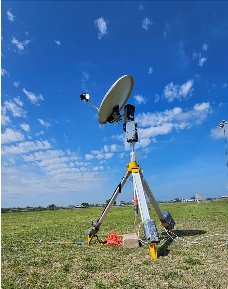
Fig. 3: Teleskop einrichten am Tag vor der Finsternis am 7. April 2024 in Hondo Texas. Der Plastikdeckel des Feeds (LNB) ist hell erleuchtet durch kleine Spiegel aufgeklebt auf den Satellitenspiegel. Dies als Beweis, dass das Teleskop korrekt ausgerichtet ist.
