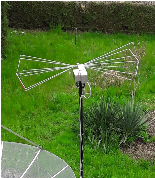
Bikon - Antenne mit Balun VHA 9103 (Schwarzbeck) mit Antennennachführung DiSEqC Controller
